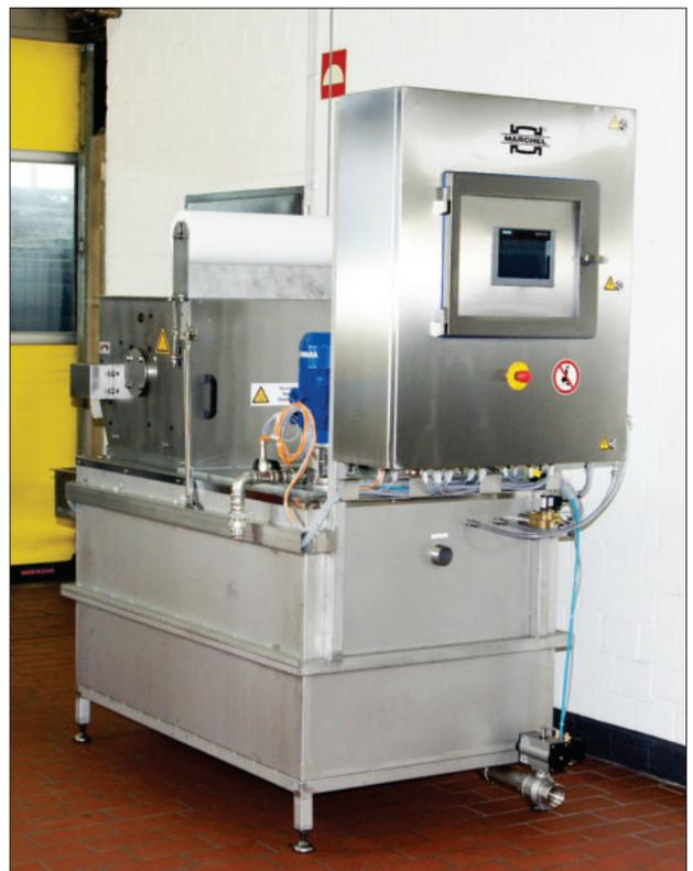
Ansicht einer Filtereinheit mit 550 Litern Brauchwasservolumen
